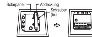
8.3 Lösen Sie die Kontakte, dann ersetzen Sie die alten Akkus durch neue Akkus und stellen die Kontakte wieder her
